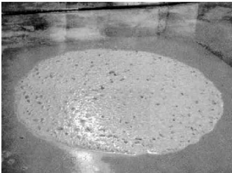
FIGURA H0306\_3 EVIDENCIA DE UN HALO DE MORTERO Y BRILLO DE AGUA
