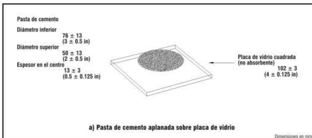
FIGURA H0206\_1 HORMIGÓN SOBRE PLACA DE VIDRIO
