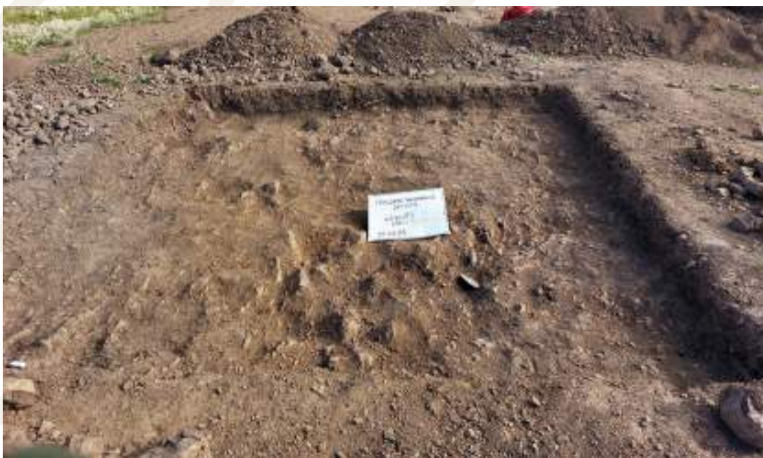
Figura 13 Presencia de roca a poca profundidad.
